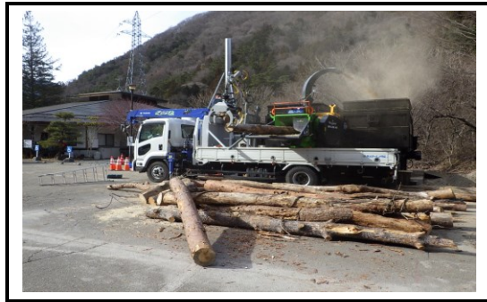
現地写真2-2 松枯損木をチップ化し燃料利用
