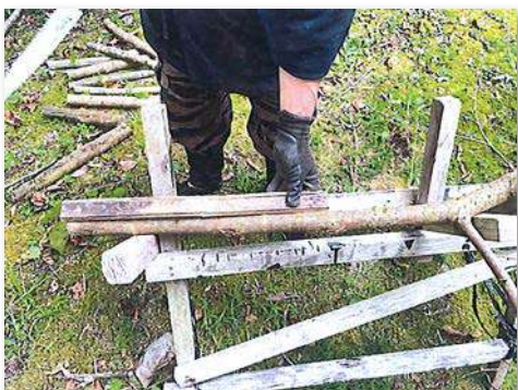
炭材の長さに切る作業
