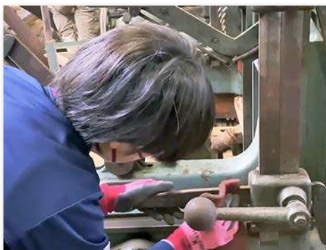
製材機の清掃を行い、細部のほこり・ゴミ・さびを除去
